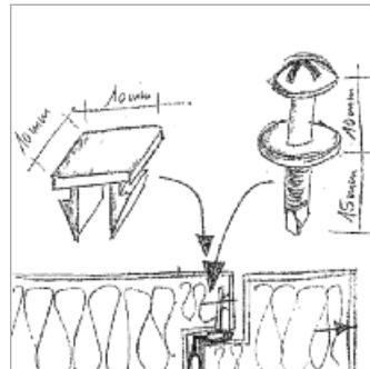
Vissé de l'extérieur; l'intérieur reste lisse et totalement propre.
