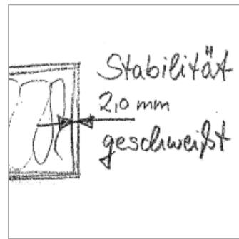
L'idée Profil plus solide avec plus de plis pour le renforcer.
